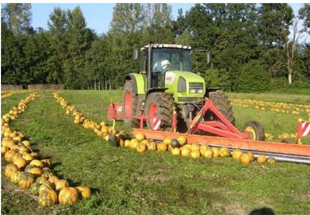
Abb. 1: einfach schwenkbarer Kürbispflug
