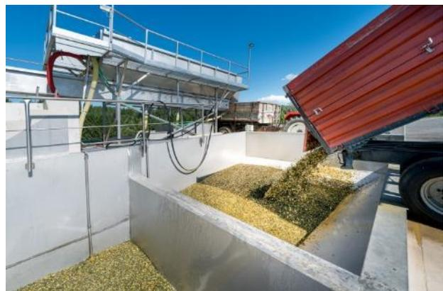
Abb. 19: Waschanlage mit Einschüttgasse
