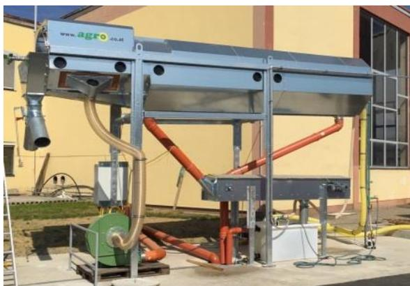
Abb. 18: Waschanlage mit Recyclingsystem
