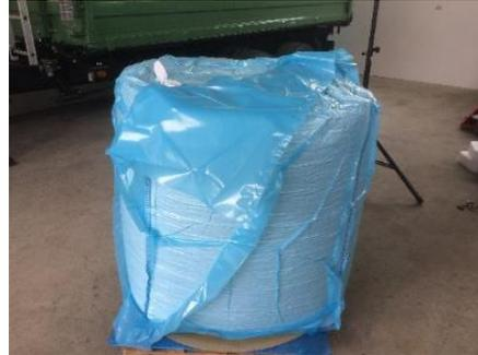
Abb. 48: Vakuumierter Big Bag
