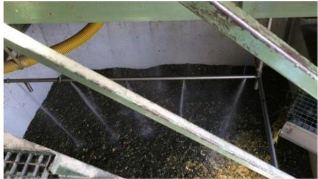
Abb. 16: Vorratsbunker mit Kernbefeuchtung
