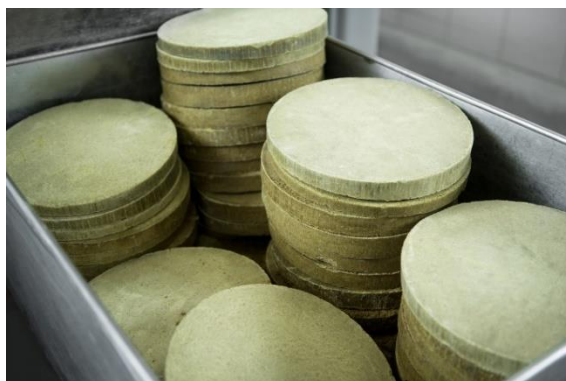
Abb. 19: Presskuchen aus Stempelpresse
