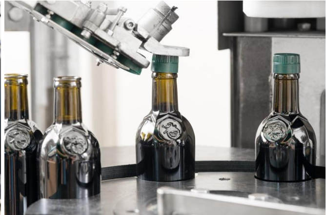
Abb. 24 & 25: automatisierte Öl-abfüllung mit Ricalverschluss
