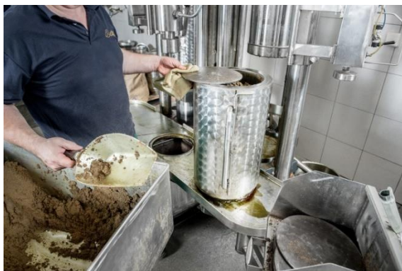
Abb. 15: Befüllen der Stempelpresse mit Zwischenplatten
