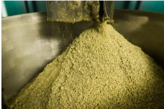
Abb. 8: Schneidemühlen erzeugen eher ein leicht rieselndes Kürbiskernmehl
