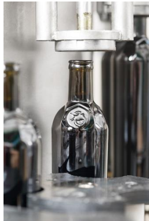
Abb. 24 & 25: automatisierte Öl-abfüllung mit Ricalverschluss
