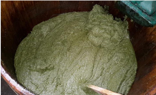
Abb. 7: in Steinmühlen wird der Kern fein zerrieben und Öl wird schon hier sichtbar
