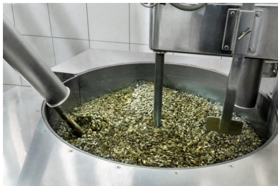
Abb. 5: Beim Nachtrocknen werden die Kerne auf 50-60 °C erwärmt.
