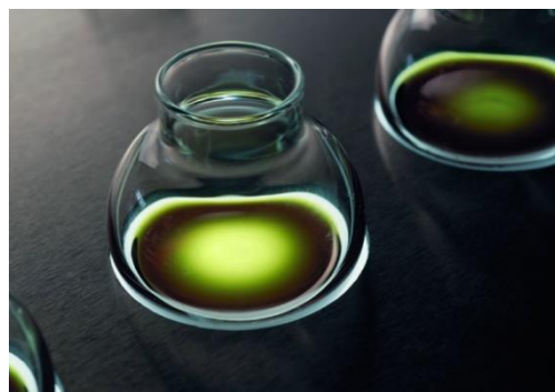
Abb. 3: typische grün-rote Zweifarbigkeit, die auf sekundären Pflanzenstoffen beruht (Chlorophyll und Carotinoide), gut erkennbar am Kernöltestgerät nach Institut Dr. Wagner.
